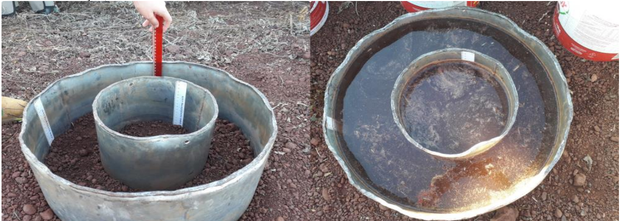
Figura 5. Determinação da velocidade básica de infiltração ( V_{ib} ) na área de pastagem extensiva (PE) utilizando anéis de infiltração, no Oeste do Estado do Maranhão, bioma Cerrado.
