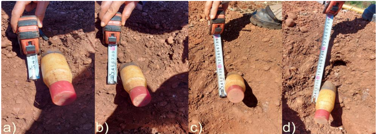
Figura 3. Coleta das amostras indeformadas de solo nas profundidades 0-5 cm (a), 5-10 cm (b), 10-20 cm (c) e 20-30 cm (d), no Oeste do Estado do Maranhão, bioma Cerrado.
