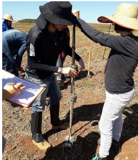
Figura 4. Determinação da resistência mecânica do solo à penetração na Área de pastagem extensiva (PE), utilizando um penetrômetro de impacto.
