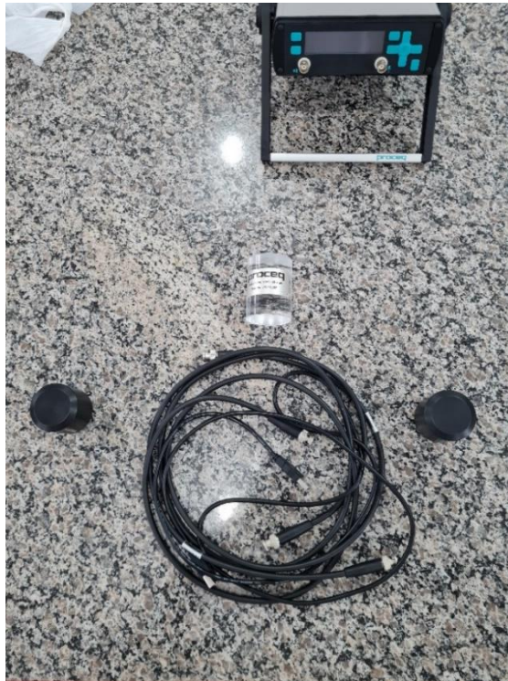
Figura 4 – Ultrassom PunditLab+, cabos coaxiais, transdutores e bloco de calibração.
