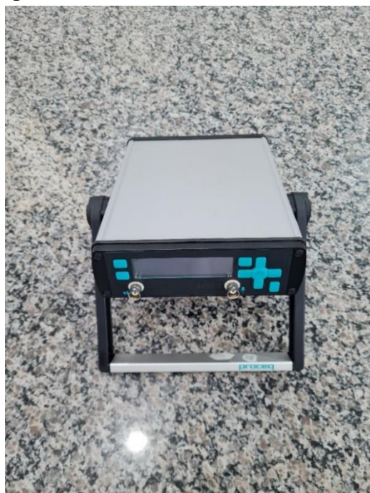
Figura 3 – Ultrassom Punditlab+ da Proceq.
