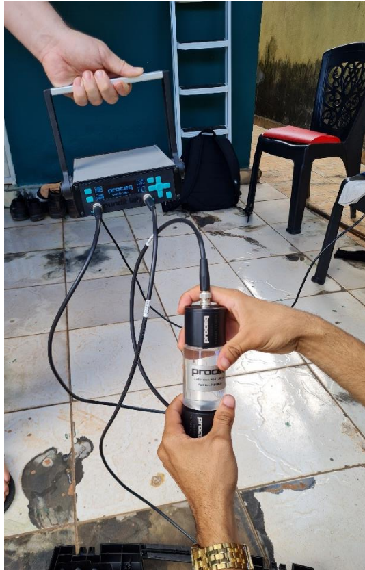
Figura 9 – Calibração dos transdutores com o bloco de calibração.
