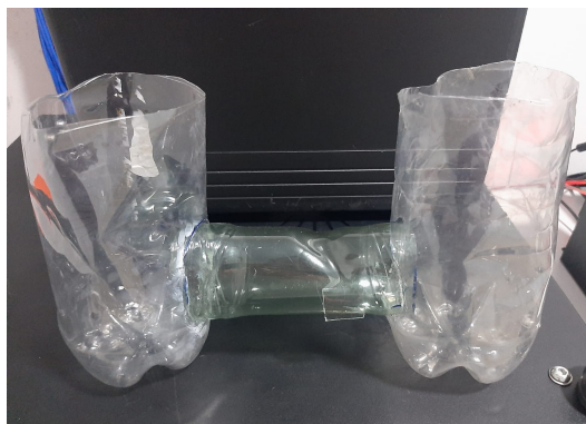
Figura 2 – Experimento de física mostrando a convecção.
