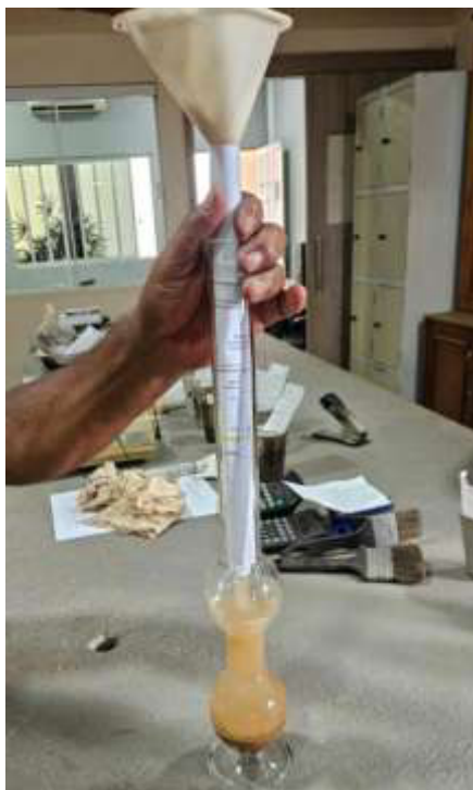
Figura 3: Utilização do frasco de Chapman.
