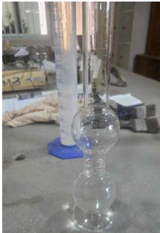
Figura 2: Frasco de Chapman com água destilada até a marcação.
