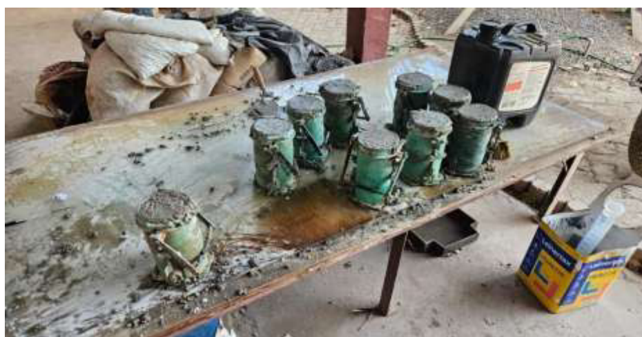
Figura 10: Concreto nos moldes de corpo de prova.
