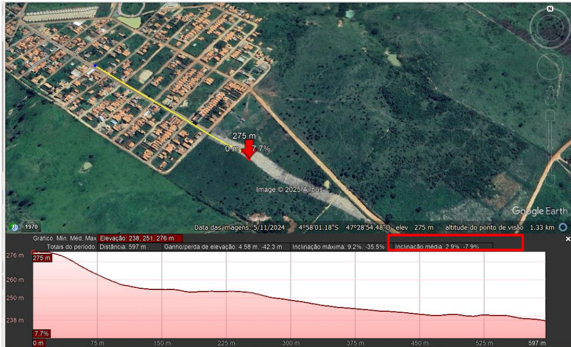
Figura 20 – Perfil longitudinal da Avenida Adelino de Andrade, indicando variações de elevação e inclinação do terreno.
