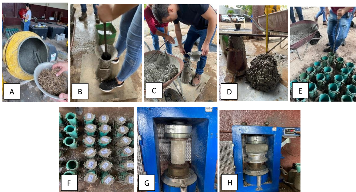
Figura 6 – Preparação do traço de concreto e ensaios.
