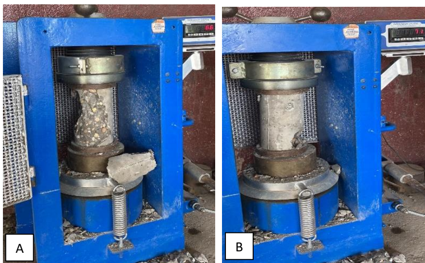
Figura 9 – Ensaio de compressão axial em CPs sem fibras (A) e com fibras (B)
