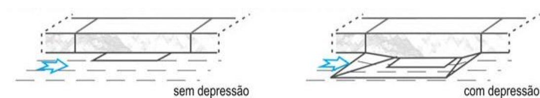
Figura 11 – Boca de lobo com fenda horizontal longitudinal
