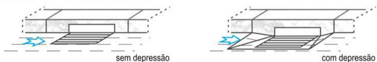
Figura 8 – Boca de lobo com grelha
