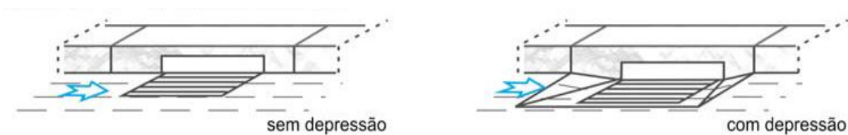
Figura 9 – Boca de lobo combinada
