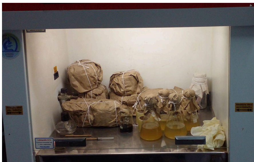
Figura 3 - Câmara de fluxo laminar com as placas de petri e os meios de cultura BDA autoclavados
