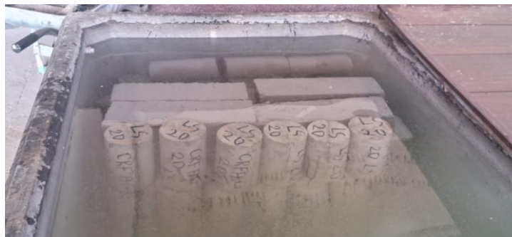
Figura 11: Corpos de provas submerso no tanque de cura.
