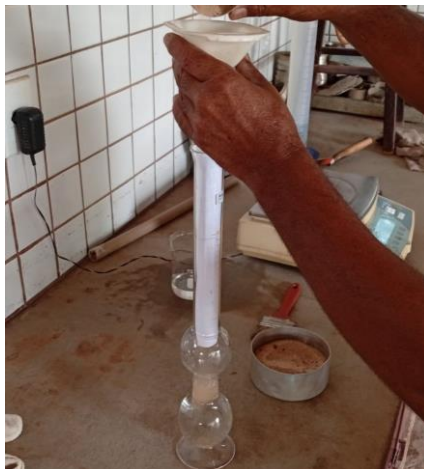
Figura 5: Adição do agregado miúdo no frasco de Chapman.
