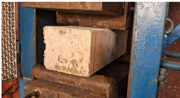
Figura 15: Posicionamento do corpo de prova prismático para o ensaio.
