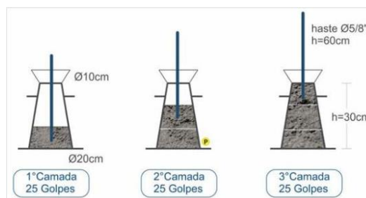
Figura 8: Procedimento de compactação das camadas.
