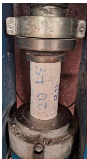
Figura 12: Corpo de prova cilíndrico posicionado na máquina de ensaio.
