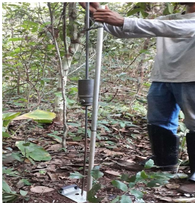
Figura 5- Penetrômetro de impacto utilizado durante a coleta de dados referente a resistência mecânica do solo, área de floresta natural (FL) no município de Porto Franco, região sul do estado do Maranhão.
