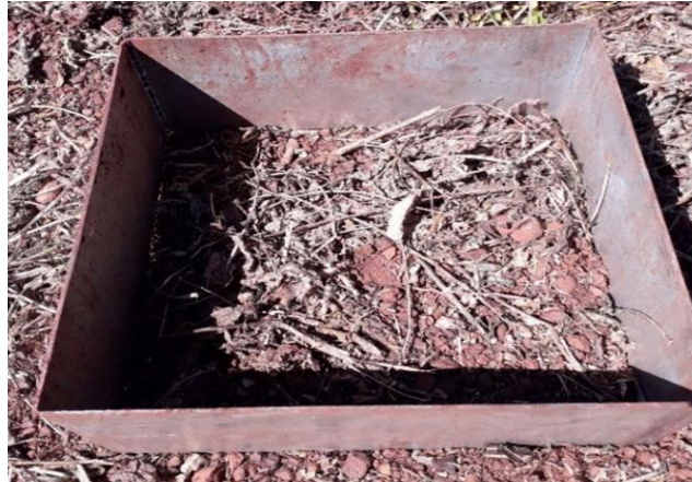
Figura 6- Monólito de metal utilizado na coleta das amostras de serrapilheira área de lavoura extensiva (LE) no município de Porto Franco, região sul do estado do Maranhão.
