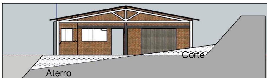
Figura 17: Ilustração do corte e aterro do terreno
