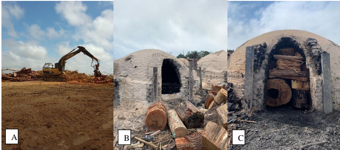
Figura 5 - Enchimento dos fornos de alvenaria com resíduos seccionados, partindo do seccionamento dos resíduos (A), deposição dos peças em frente aos fornos (B) e enchimento (C).
