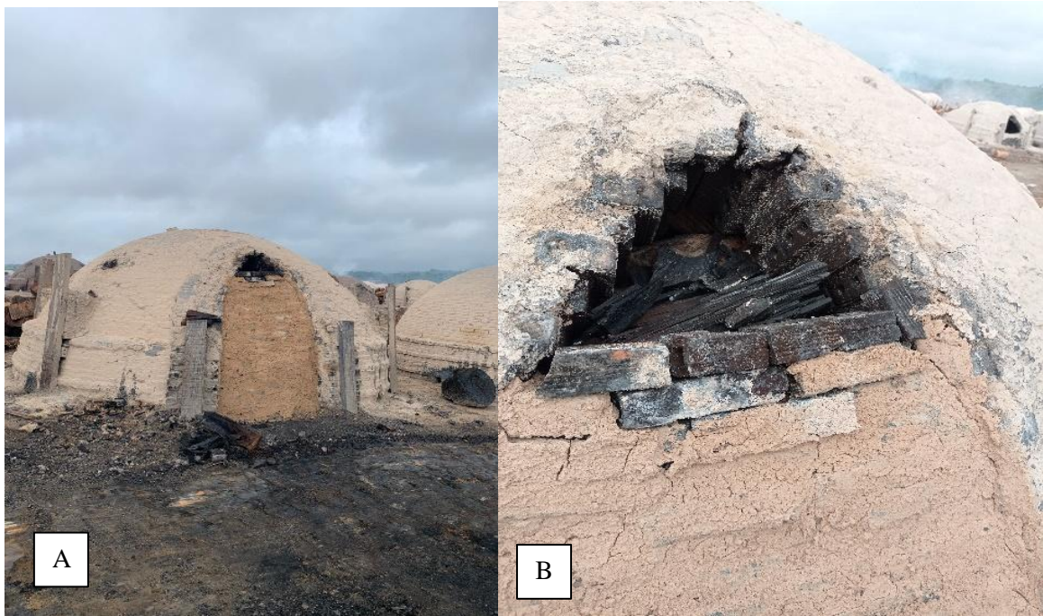
Figura 6 – Ignição das madeiras residuais por meio de aberturas denominada de ninhos.
