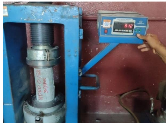
Figuras 74 e 75 – Rompimento do corpo de prova e contra-prova com fibras de vidro 0,5% com 3 dias de cura.
