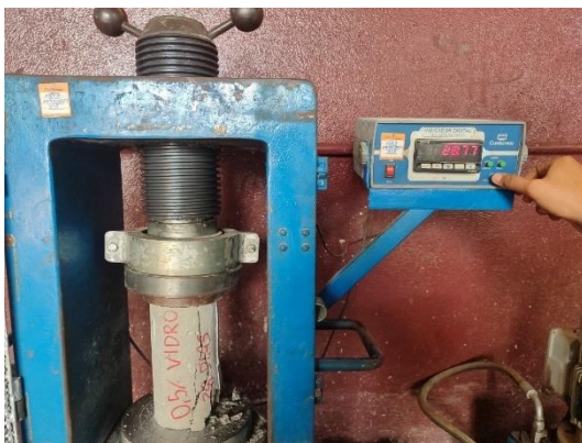
Figuras 98 e 99 – Rompimento do corpo de prova e contra-prova com fibra de vidro 0,5%.
