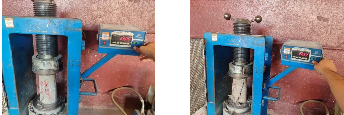
Figuras 121 e 122 – Rompimento do corpo de prova e contra-prova com fibra de aço 0,75% exposto ao cloreto, no ensaio de compressão axial.
