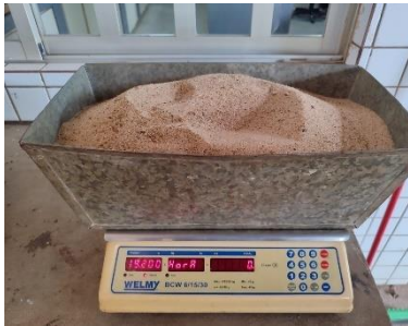
Figuras 58, 59 e 60 – Pesagem do cimento e dos agregados grão e miúdo.
