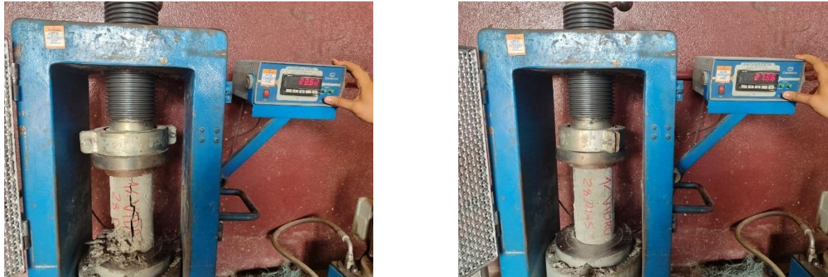
Figuras 100 e 101 – Rompimento do corpo de prova e contra-prova com adição de fibras de vidro 1%.
