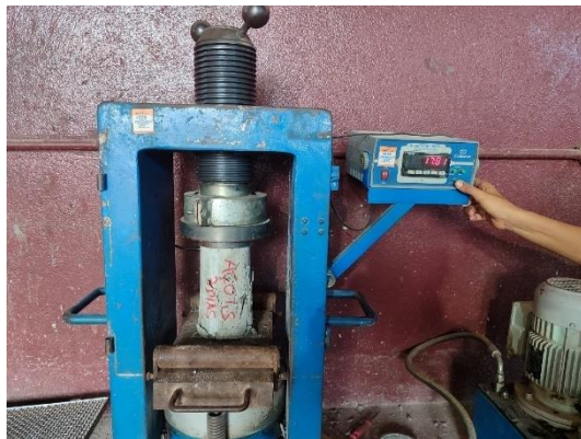
Figuras 82 e 83 – Rompimento corpo de prova e contra-prova com fibras de aço 1,5% com 7 dias de cura.
