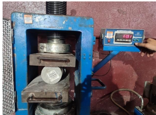
Figuras 129 e 130 – Rompimento do corpo de prova e contra-prova com fibra de aço 0,75% exposto ao sulfato de sódio, no ensaio de tração por compressão diametral.
