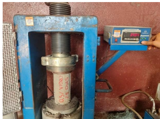
Figuras 98 e 99 – Rompimento do corpo de prova e contra-prova com fibra de vidro 0,5%.
