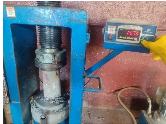
Figuras 111 e 112 – Rompimento do CP com fibra de aço 1,5% exposto ao sulfato, no ensaio de compressão axial.
