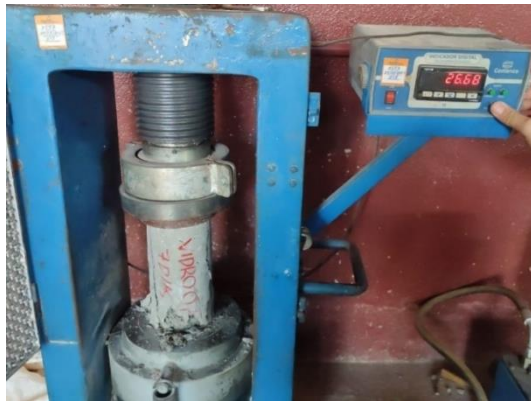
Figuras 89 e 90 – Rompimento do corpo de prova e contra-prova com fibra de vidro 1%.
