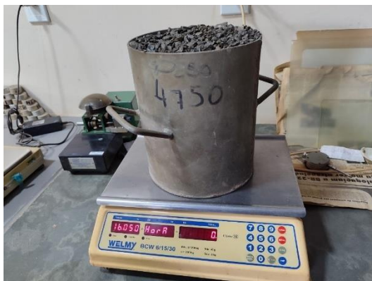
Figuras 11 e 12 – Brita compactada e pesagem do material.
