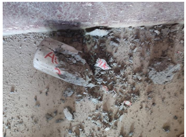
Figuras 84 e 85 – Detalhe dos corpos de prova com fibras de aço 0,75% e 1,5% rompidos com 7 dias de cura.
