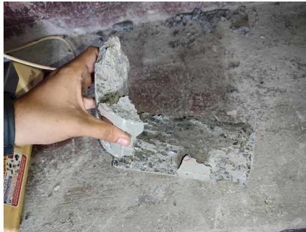
Figura 97 – Detalhe do CP com adição de fibras de aço rompido.
