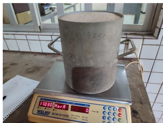
Figuras 18 e 19 – Areia pesada em estado solto e compactada.
