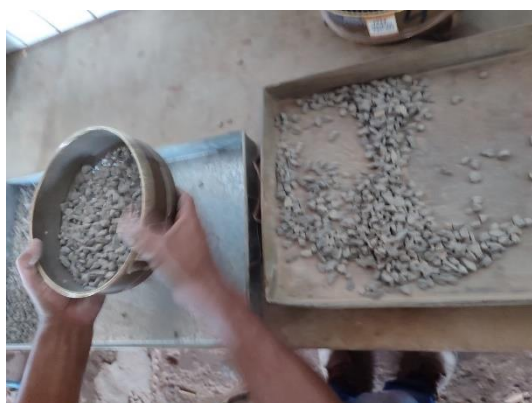
Figuras 13 e 14 – Peneiramento da brita com a peneira e pesagem do material retido na peneira.
