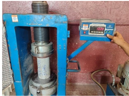
Figuras 72 e 73 – Rompimento do corpo de prova e contra-prova com fibra de aço 1,5 para rompimento com 3 dias de cura.
