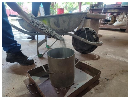
Figuras 9 e 10 – Brita sendo despejada livremente e pesagem do material.
