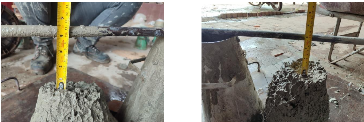
Figuras 146 e 147 – Slump após adição de aditivo plastificante com o equilíbrio na dosagem para alcance da trabalhabilidade ideal adotada, entre 8 e 10 cm.
