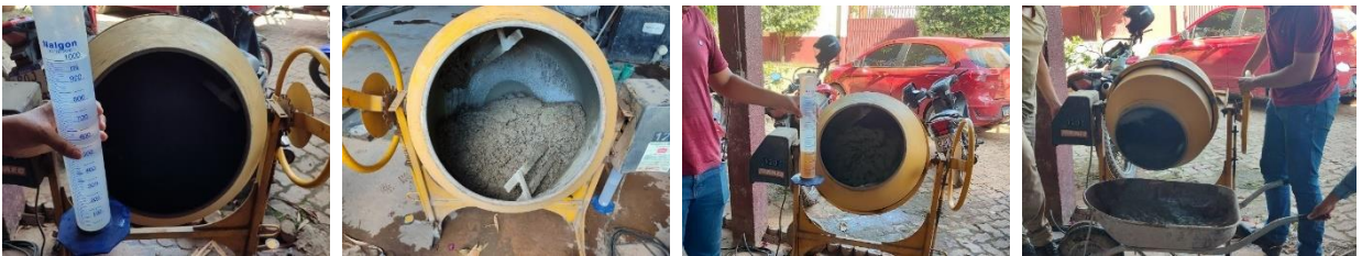
Figuras 33, 34, 35 e 36 – Processo de concretagem do traço.
