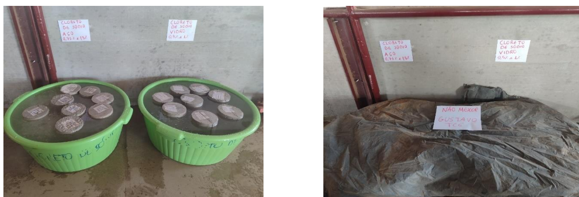
Figuras 107 e 108 – Corpos de prova com fibras de aço e vidro expostas ao cloreto de sódio e protegidos por lona para não evaporação da água e evitar qualquer contato externo.
