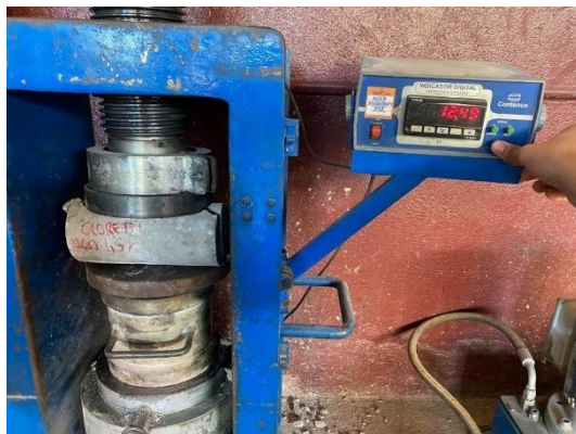
Figuras 131 e 132 – Rompimento do corpo de prova e contra-prova com fibra de aço 1,5% exposto ao cloreto de sódio, no ensaio de tração por compressão diametral.
