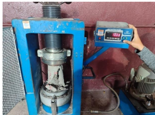
Figuras 93 e 94 – Rompimento do corpo de prova e contra-prova com adição de 0,75% de fibras de aço.
