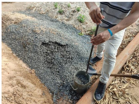
Figuras 11 e 12 – Brita compactada e pesagem do material.
