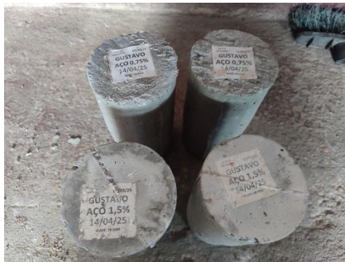
Figura 92 – Corpos de prova com adição de 0,75% e 1,5% aos 28 dias de cura.
