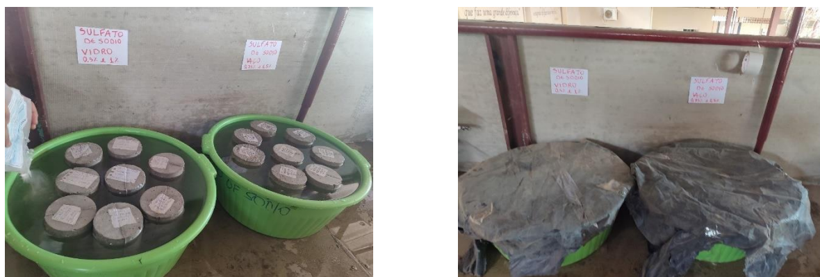
Figuras 105 e 106 – Corpos de prova com fibras de aço e vidro expostas ao sulfato de sódio protegidos por lona para não evaporação da água e evitar qualquer contato externo.
