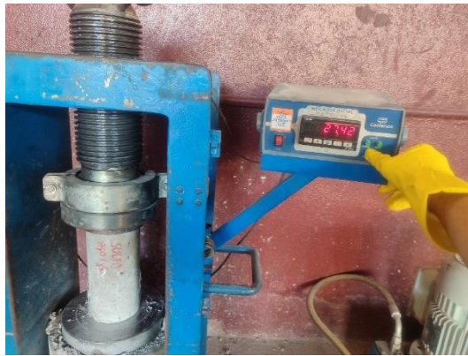
Figuras 111 e 112 – Rompimento do CP com fibra de aço 1,5% exposto ao sulfato, no ensaio de compressão axial.
