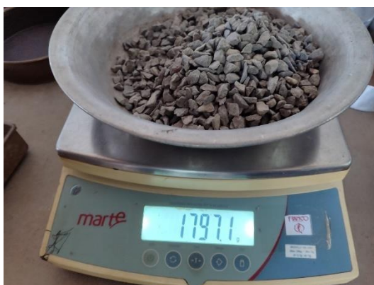
Figuras 13 e 14 – Peneiramento da brita com a peneira e pesagem do material retido na peneira.
