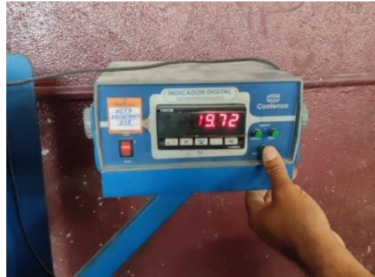
Figuras 70 e 71 – Rompimento do corpo de prova e contra-prova com fibra de aço 0,75 aos 3 dias de cura.
