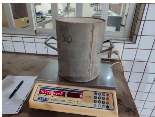
Figuras 18 e 19 – Areia pesada em estado solto e compactada.
