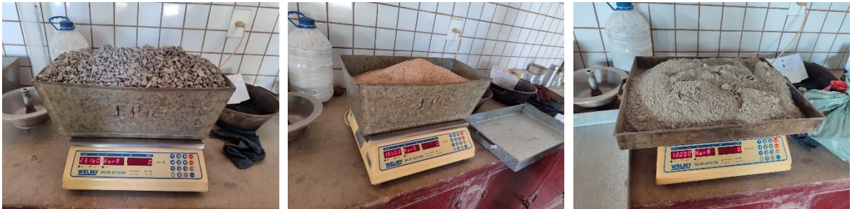
Figuras 30, 31 e 32 – Pesagem do cimento e dos agregados graúdo e miúdo.
