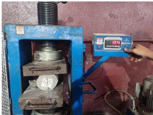
Figuras 129 e 130 – Rompimento do corpo de prova e contra-prova com fibra de aço 0,75% exposto ao sulfato de sódio, no ensaio de tração por compressão diametral.
