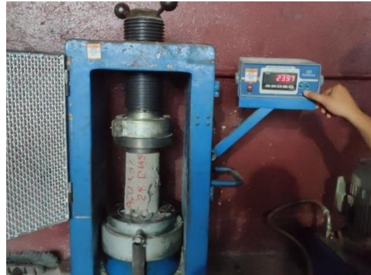
Figuras 95 e 96 – Rompimento do corpo de prova e contra-prova com adição de 1,5% de fibras de aço.
