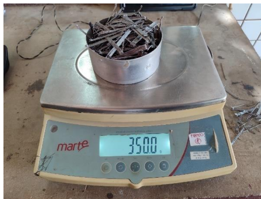
Figura 43 – Pesagem das fibras de aço para teor de 1,5%.
