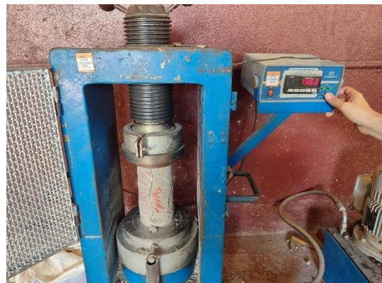
Figuras 89 e 90 – Rompimento do corpo de prova e contra-prova com fibra de vidro 1%.
