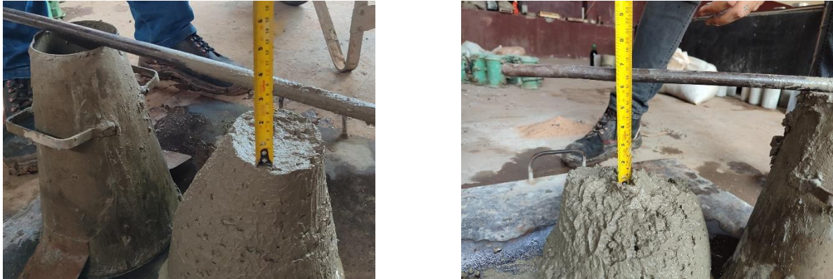
Figuras 144 e 145 – Slump sem adição de aditivo plastificante, e com adição de aditivo antes de equilibrar a dosagem.
