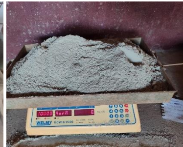
Figuras 58, 59 e 60 – Pesagem do cimento e dos agregados grão e miúdo.
