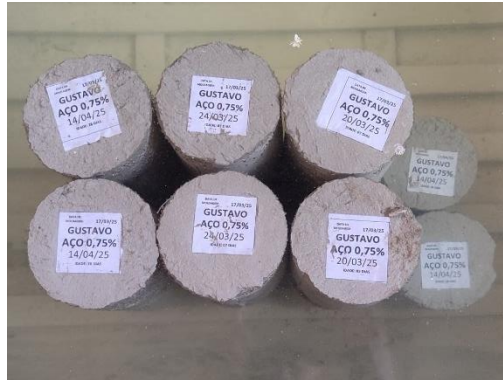
Figura 42 – Imersão em água dos corpos de prova de aço 0,75% para início da cura.
