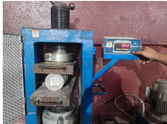
Figuras 129 e 130 – Rompimento do corpo de prova e contra-prova com fibra de aço 0,75% exposto ao sulfato de sódio, no ensaio de tração por compressão diametral.
