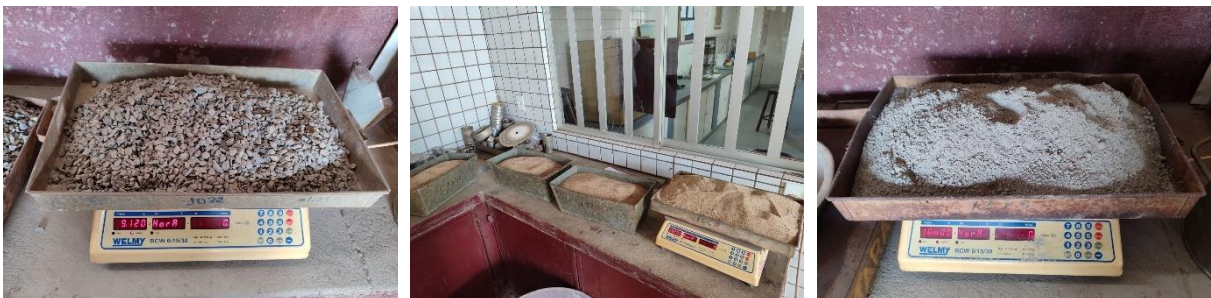
Figuras 44, 45 e 46 – Pesagem do cimento, agregados graúdo e miúdo.
