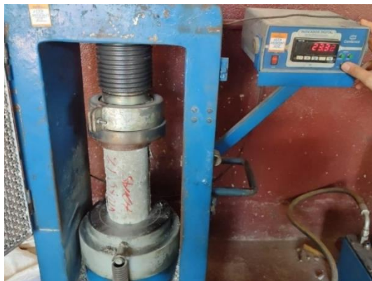
Figuras 89 e 90 – Rompimento do corpo de prova e contra-prova com fibra de vidro 1%.
