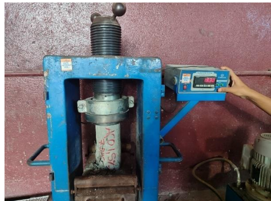
Figuras 82 e 83 – Rompimento corpo de prova e contra-prova com fibras de aço 1,5% com 7 dias de cura.
