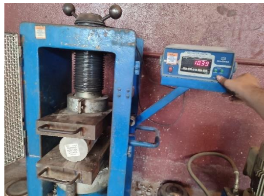
Figuras 131 e 132 – Rompimento do corpo de prova e contra-prova com fibra de aço 1,5% exposto ao cloreto de sódio, no ensaio de tração por compressão diametral.
