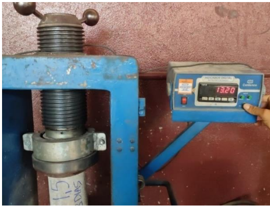
Figuras 72 e 73 – Rompimento do corpo de prova e contra-prova com fibra de aço 1,5 para rompimento com 3 dias de cura.
