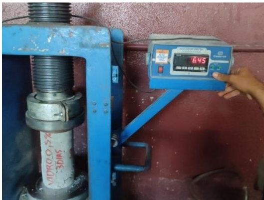
Figuras 74 e 75 – Rompimento do corpo de prova e contra-prova com fibras de vidro 0,5% com 3 dias de cura.
