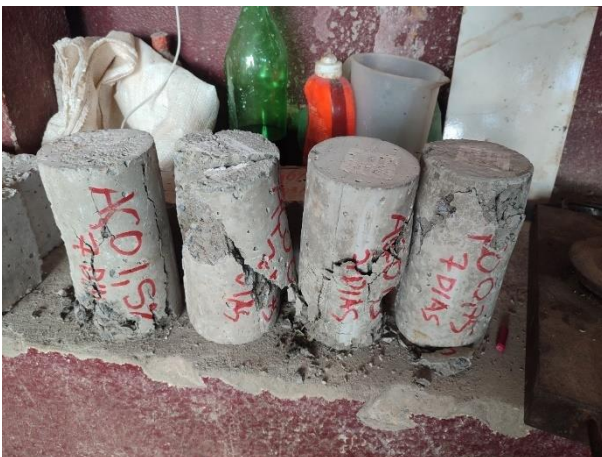
Figuras 84 e 85 – Detalhe dos corpos de prova com fibras de aço 0,75% e 1,5% rompidos com 7 dias de cura.
