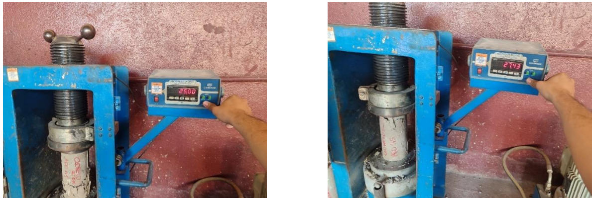
Figuras 119 e 120 – Rompimento do corpo de prova e contra-prova com fibra de aço 1,5% exposto ao cloreto, no ensaio de compressão axial.
