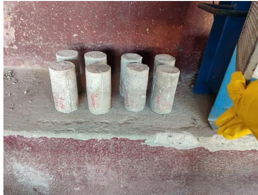
Figura 110 – CP's com fibras de aço 1,5% e 0,75% após exposição ao sulfato de sódio.
