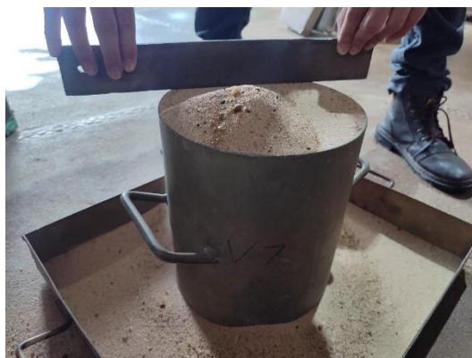
Figura 17 – Areia despejada de forma livre no recipiente ajustada para pesagem.
