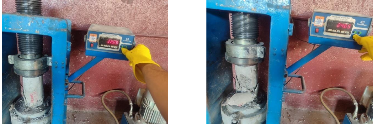
Figuras 113 e 114 – Rompimento do corpo de prova e contra-prova com fibra de aço 0,75% exposto ao sulfato, no ensaio de compressão axial.
