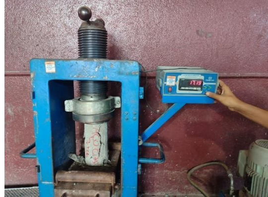
Figuras 80 e 81 – Rompimento do corpo de prova e contra-prova com fibras de aço 0,75% com 7 dias de cura.
