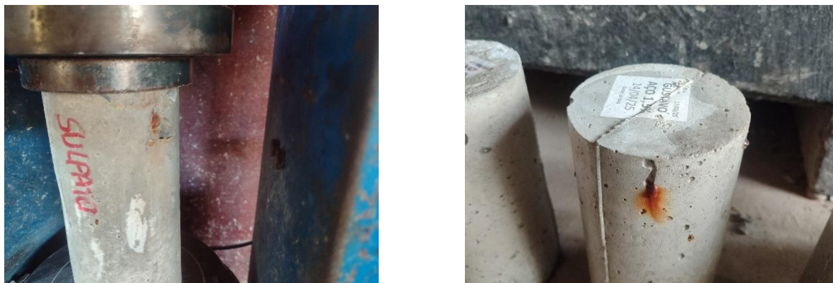
Figuras 150 e 151 – Corpos de prova expostos ao sulfato de sódio apresentando manifestações patológicas.
