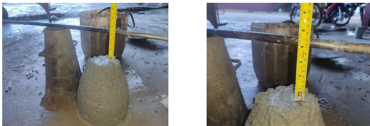
Figuras 67 e 68 – Medida do slump dos traços para as fibras de vidro 0,5 e 1 adicionadas.
