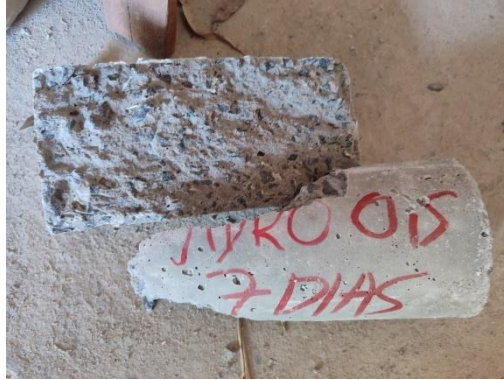
Figura 91 – Detalhe do CP com fibra de vidro 0,5% rompida.
