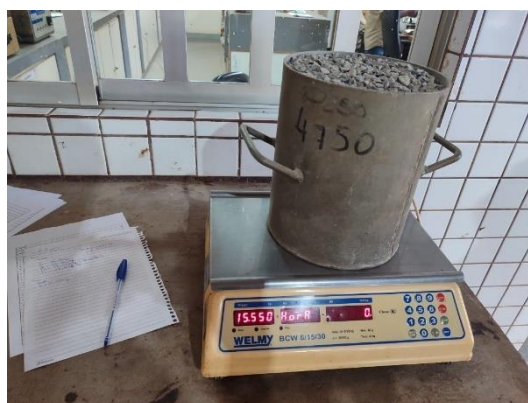
Figuras 9 e 10 – Brita sendo despejada livremente e pesagem do material.
