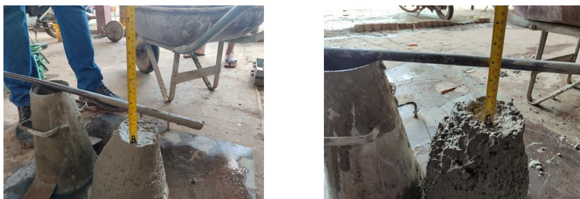
Figuras 65 e 66 – Medida do slump dos traços para as fibras de aço 0,75 e 1,5 adicionadas.
