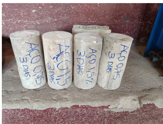
Figura 69 – Corpos de prova com fibras de aço nos dois teores com 3 dias de cura.
