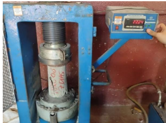
Figuras 89 e 90 – Rompimento do corpo de prova e contra-prova com fibra de vidro 1%.
