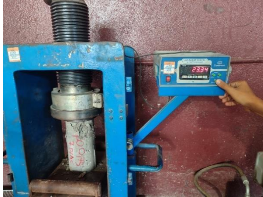
Figuras 80 e 81 – Rompimento do corpo de prova e contra-prova com fibras de aço 0,75% com 7 dias de cura.
