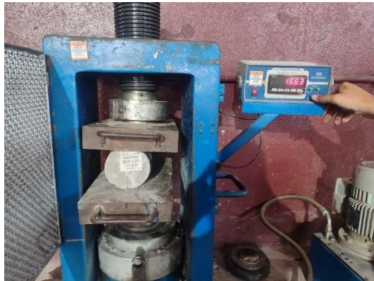
Figuras 129 e 130 – Rompimento do corpo de prova e contra-prova com fibra de aço 0,75% exposto ao sulfato de sódio, no ensaio de tração por compressão diametral.
