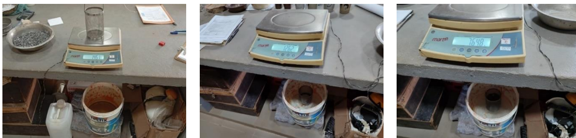
Figuras 6, 7 e 8 - Massa específica e absorção de água do agregado graúdo.
