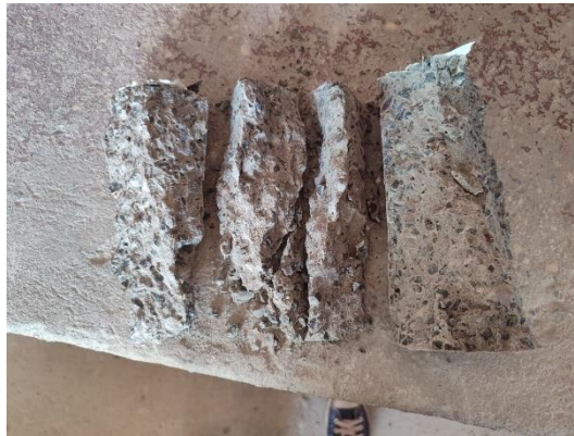
Figura 102 – Detalhe do corpo de prova com fibra de vidro adicionada rompido.
