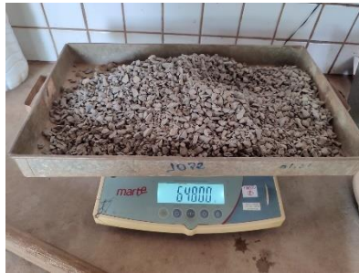
Figuras 58, 59 e 60 – Pesagem do cimento e dos agregados grão e miúdo.
