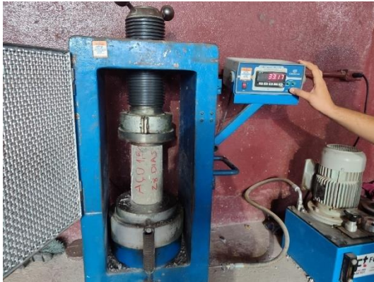
Figuras 95 e 96 – Rompimento do corpo de prova e contra-prova com adição de 1,5% de fibras de aço.
