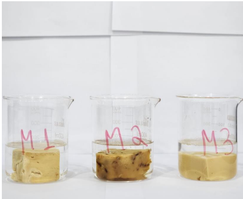
Figura 7 - Amostras durante teste de resistência à água.
