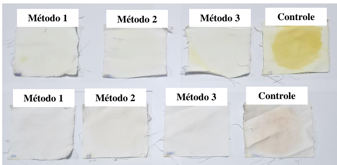
Figura 10 - Teste de lavagem das manchas dos tecidos.
