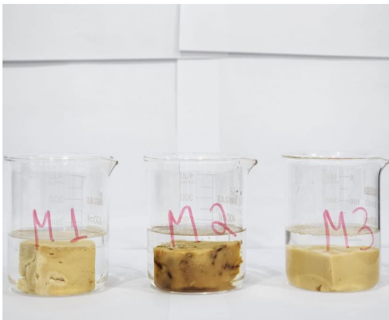
Figura 7 - Amostras durante teste de resistência à água.
