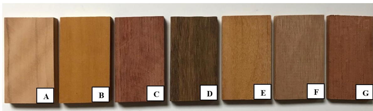
Figura 1. Corpos de prova de espécies florestais da Amazônia Ocidental. A. Peroba - Aspidosperma polyneuron ; B. Amarelão - Aspidosperma sp.; C. Jatobá - Hymenaea courbaril ; D. Ipê - Handroantus serratifolius ; E. Garapa - Apuleia leiocarpa ; F. Tauari – Couratari oblongifolia ; G. Cedro - Cedrela odorata .
