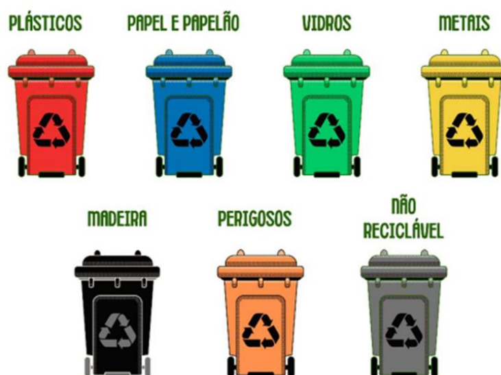
Figura 10 - Código de cores para resíduos da construção civil.
