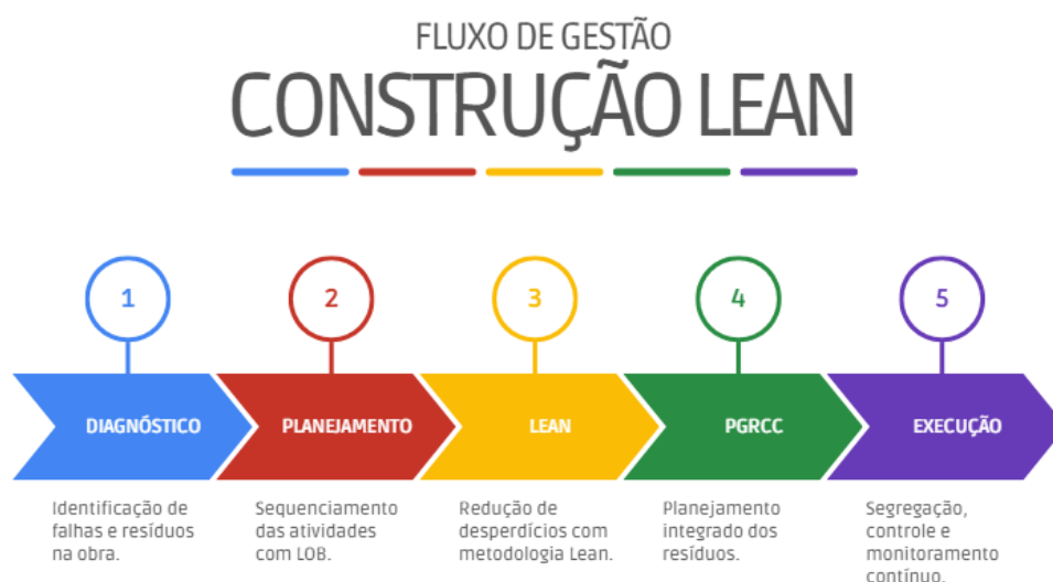
Figura 11 - Fluxograma de aplicação da Linha de Balanço integrada à gestão de resíduos.
