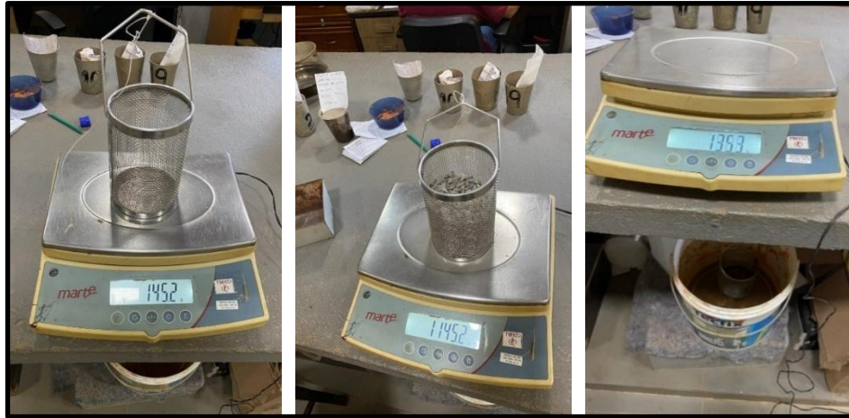
Figura 3 – Ensaio da massa específica do agregado graúdo.
