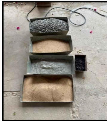
Figura 7 – Materiais utilizados no concreto.
