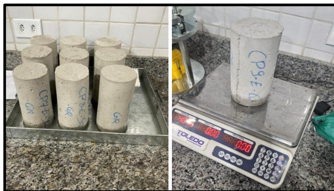
Figura 10 – Etapa do teste de capilaridade.
