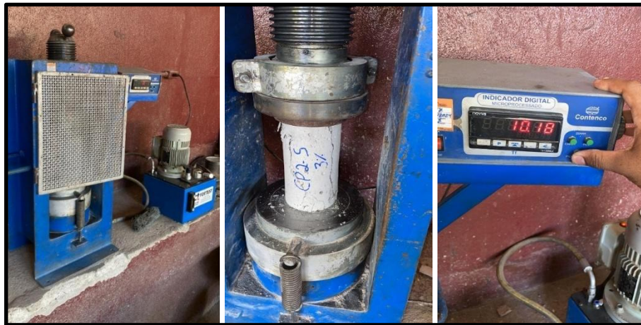
Figura 12 – Rompimento do concreto para o ensaio de resistência a compressão.
