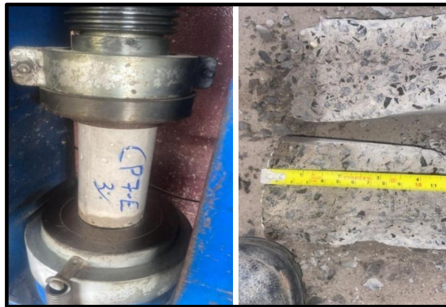
Figura 11 – Etapa de rompimento do ensaio de capilaridade.
