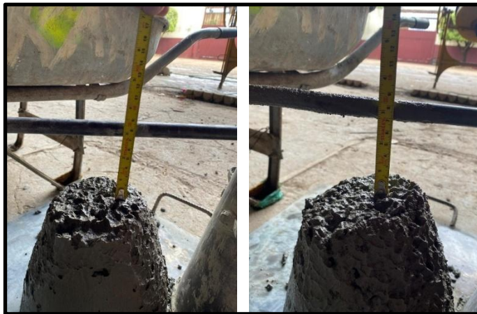
Figura 8 – Teste de abatimento.
