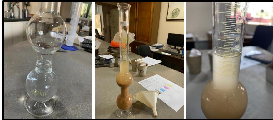
Figura 2 – Ensaio da massa específica do agregado miúdo pelo método Chapman.
