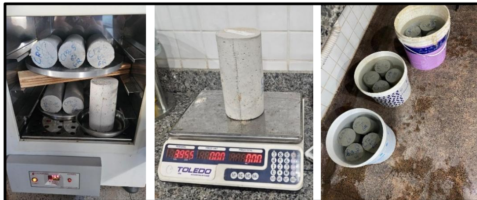
Figura 9 – Teste de absorção do concreto.
