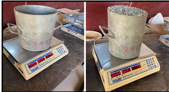
Figura 1 – Massa do recipiente vazio e massa do recipiente com o agregado graúdo.
