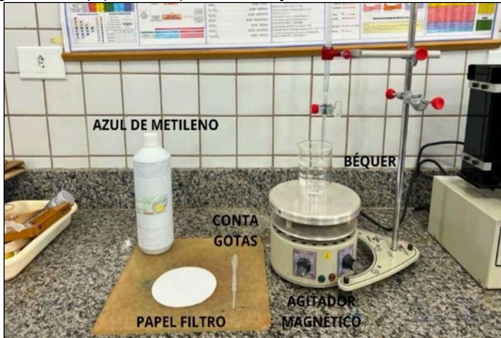
Figura 36 – Equipamentos para a realização do ensaio de azul de metileno
