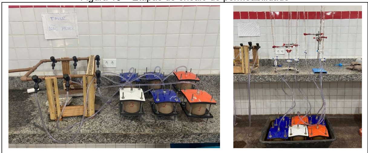
Figura 18 – Etapas de ensaio de permeabilidade
