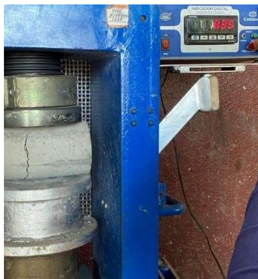
Imagem 7 – Ensaio de Tração por Compressão Diametral. Fonte: Autora (2023).
