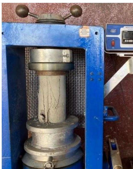
Imagem 6 – Ensaio de Compressão Axial Fonte: Autora (2023).
