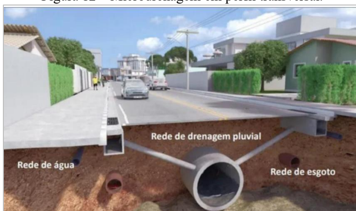
Figura 12 – Microdrenagem em perfil transversal.
