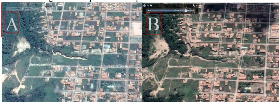
Figura 22 -Expansão da feição erosiva no ano de 2017 e 2018.
