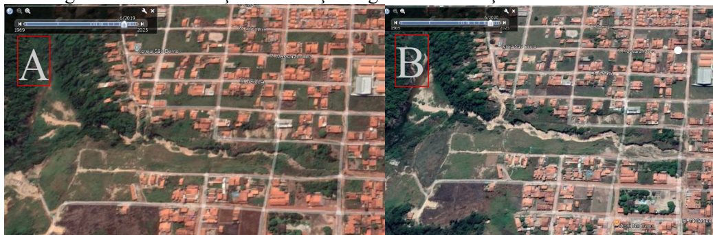
Figura 23- Intensificação do avanço longitudinal da voçoroca em 2019 e 2020.
