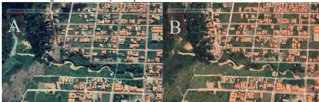
Figura 25- Reativação do processo erosivo na área aterrada em 2023 e 2024.
