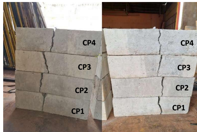
Figura 33: CPPs do traço REF em estágio pós-ruptura.
