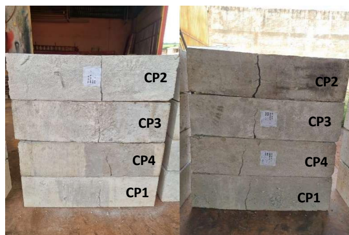
Figura 35: CPPs do traço FAÇO2,19 em estágio pós-ruptura.
