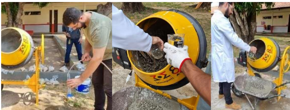
Figura 11: Realização de acréscimos com proveta graduada e béquer.
