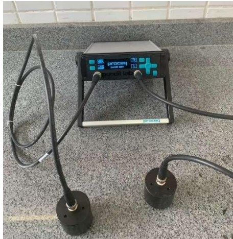
Figura 28: Aparelho de Ultrassom PROCEQ Pundit Lab+.
