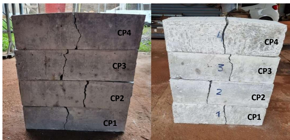
Figura 39: CPPs do traço FACM0,45 no estágio pós-ruptura.
