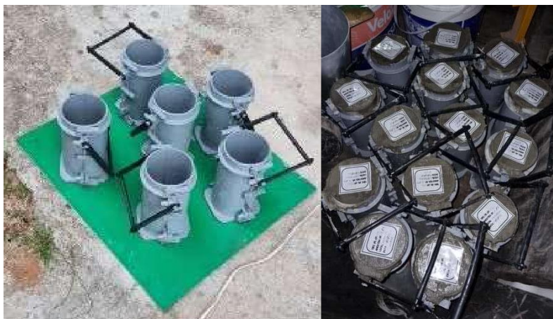
Figura 21: Moldes e corpos de prova cilíndricos.
