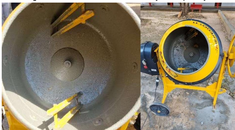
Figura 6: Interior da betoneira com traço de imprimação.
