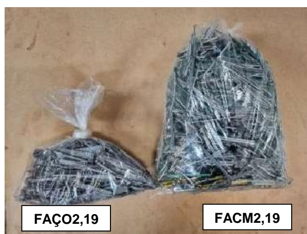
Figura 23: Fibras incorporadas nos traços FAÇO2,19 e FACM2,19.
