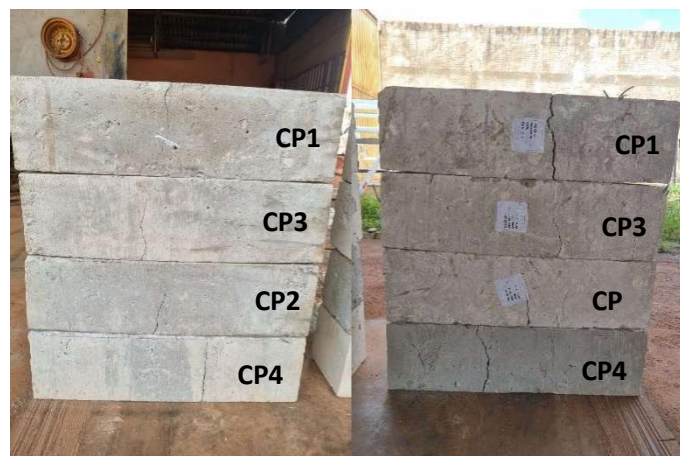
Figura 37: CPPs do traço FACM2,19 em estágio pós-ruptura.
