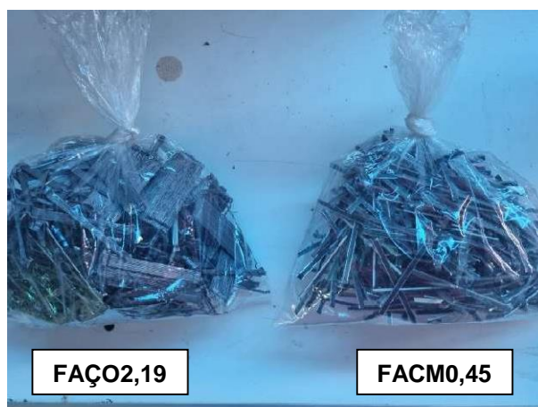
Figura 24: Fibras incorporadas nos traços FAÇO2,19 e FACM0,45.
