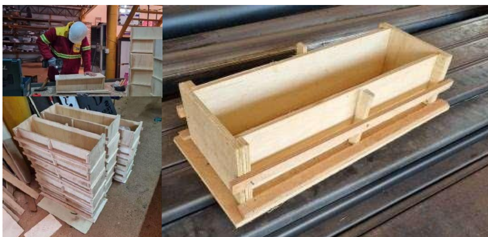
Figura 22: Molde de corpo de prova prismáticos em compensado.
