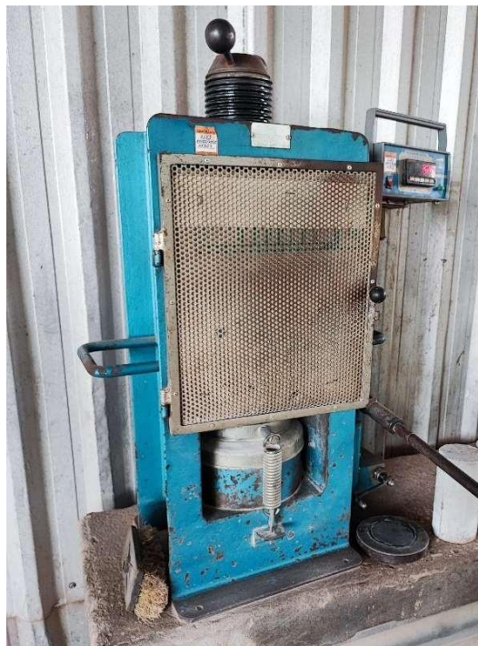
Figura 25: Prensa Hidráulica Pavitest I.30001.C.
