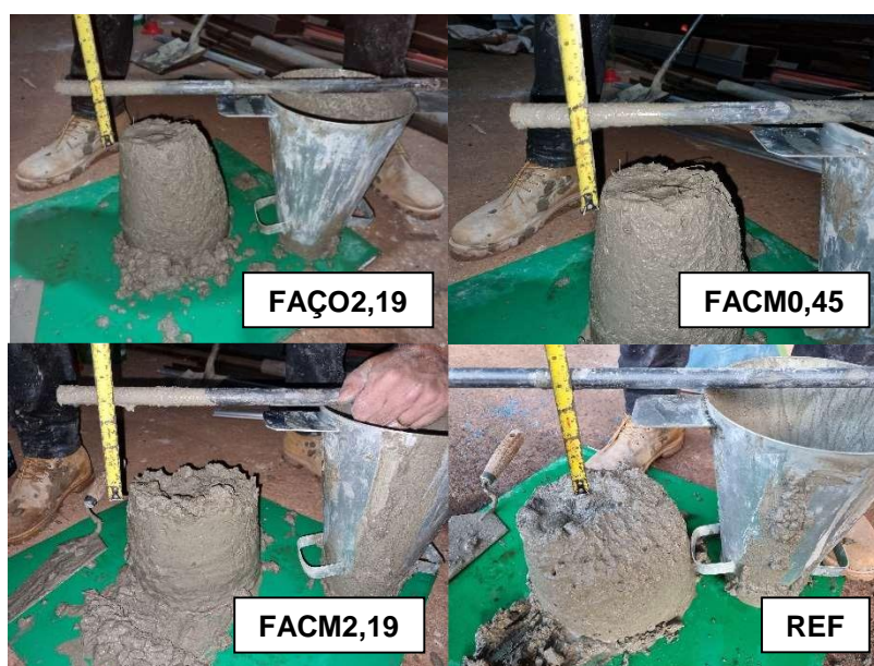
Figura 30: Resultados de Slump test .
