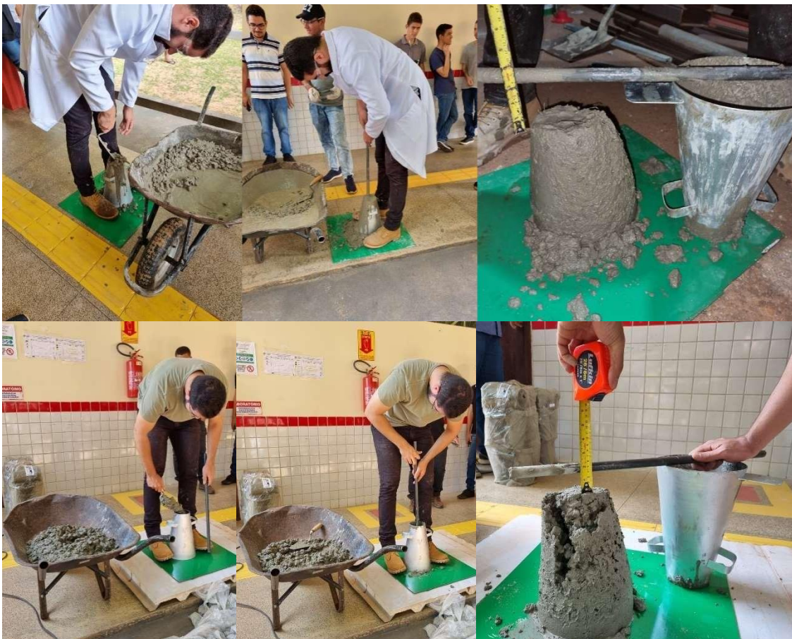
Figura 12: Realização do ensaio de Abatimento do concreto fresco ( Slump test ).
