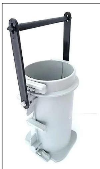
Figura 20: Molde de corpo de prova cilíndrico em polímero de alta densidade.
