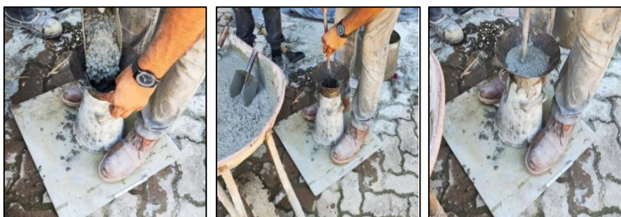
Figura 13. Registros fotográficos do teste de abatimento de cone
