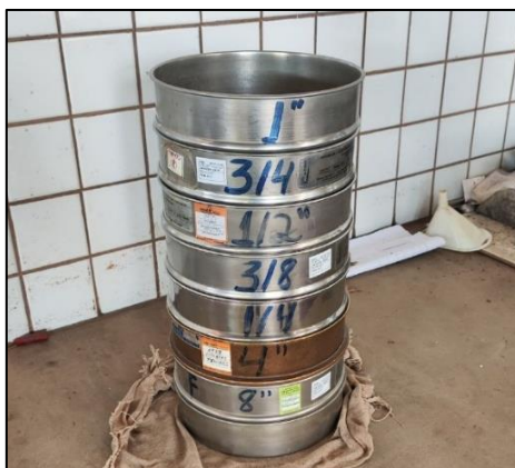
Figura 5. Peneiras com diferentes aberturas para separação granulométrica
