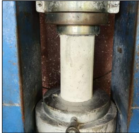
Figura 10. Corpo de prova cilíndrico na máquina de ensaio
