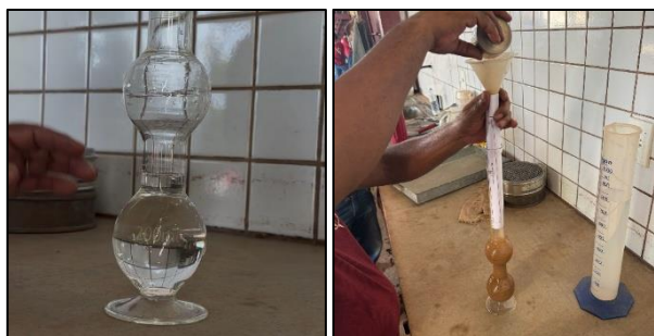
Figura 6. Frasco de Chapman para ensaios de densidade do grão mineral
