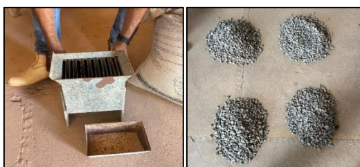
Figura 4. Separador de amostras e quarteamento do agregado graúdo
