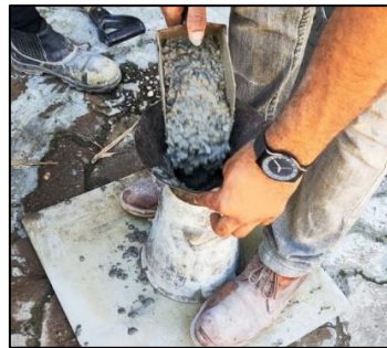
Figura 9. Preenchimento do cone de slump test
