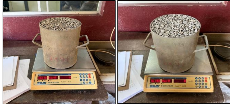
Figura 8. Pesagem da brita sem compactação e com compactação
