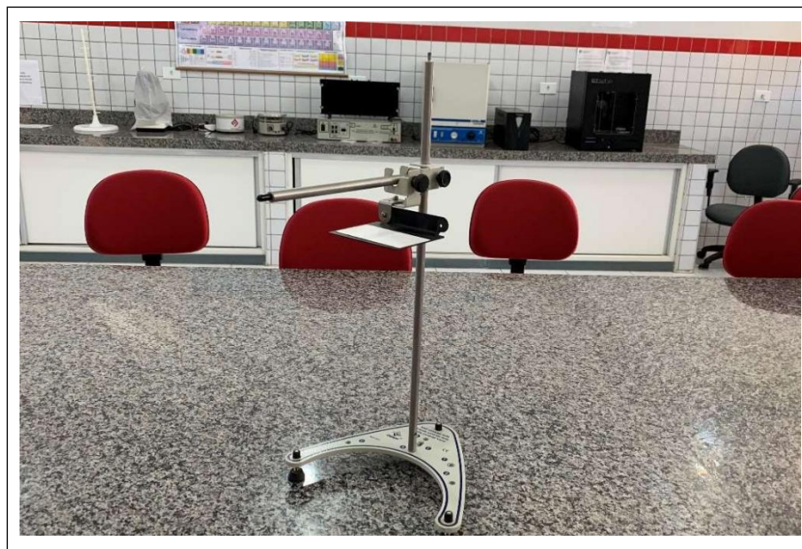
Figura 6 – Suporte para o teste de repetibilidade.
