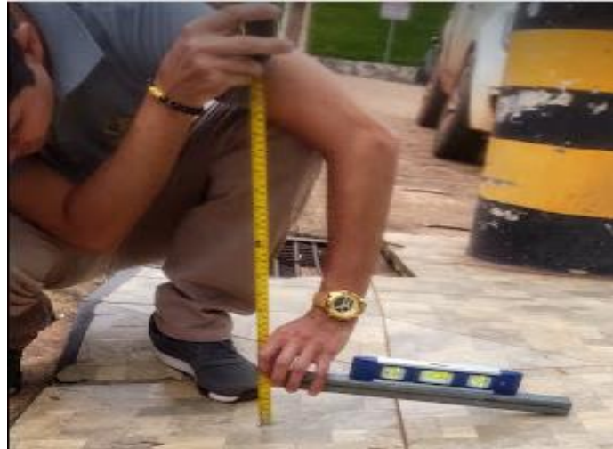
Figura 03- Detalhamento de nível da rampa
