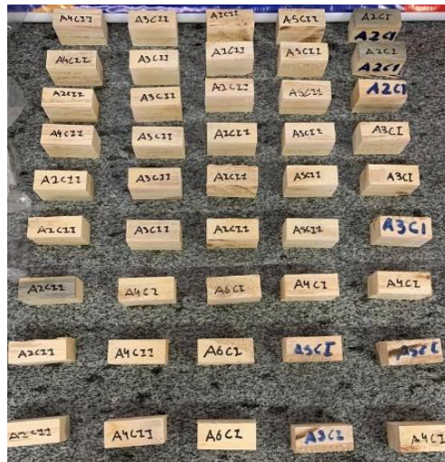
Figura 4 – Corpos de provas de madeira de K. grandifoliola produzidos para os ensaios físicos da madeira.
