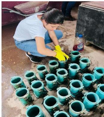
*Imagem 2: Aplicação de óleo vegetal nos moldes dos corpos de prova.*
