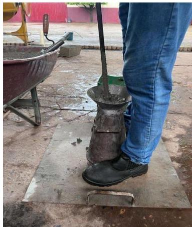
*Imagem 4: Ensaio de Slump Test.*
