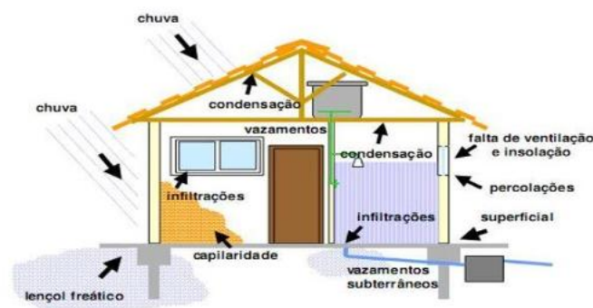
Figura 5 – Agentes responsáveis por manchas em elementos construtivos.
