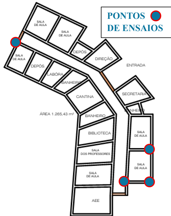
Figura 25 – Pontos de ensaio com Ultrassom nos pilares do prédio.
