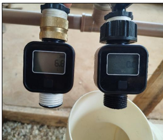
Figura 25: dispositivos medidores de vazão de água e volume.
