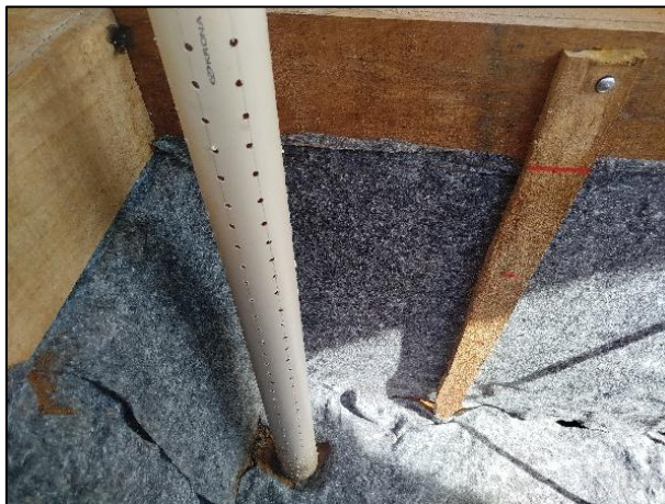
Figura 34: encanação que permite a medição do nível de água.
