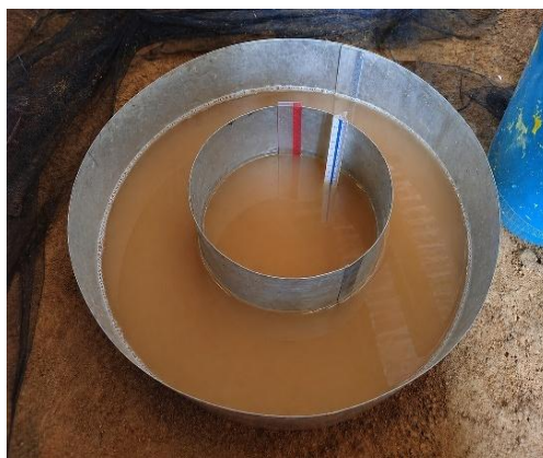
Figura 20: réguas e escalímetro utilizado no ensaio de infiltrômetro de anel.
