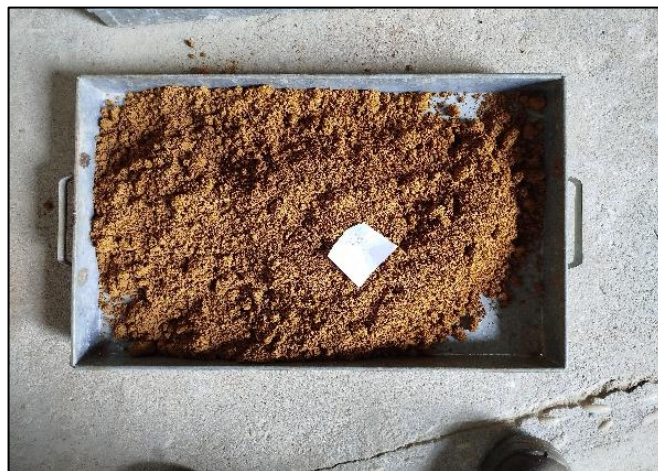
Figura 21: amostra de solo para ensaio de granulometria.
