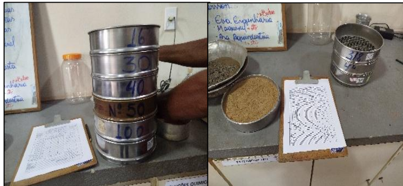
Figura 23: conjunto de peneiras utilizadas no ensaio de granulometria.
