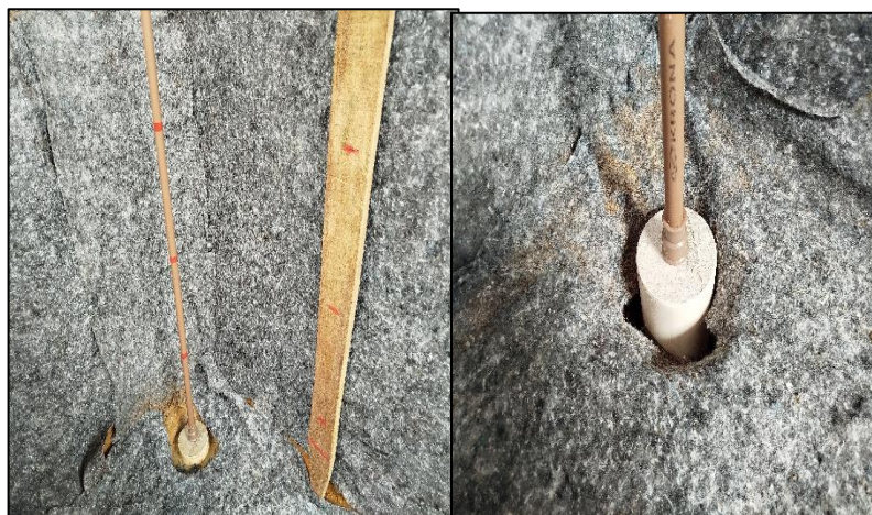
Figura 37: disposição ilustrada do posicionamento do tubo PVC 20mm.
