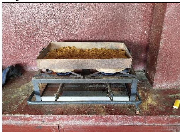
Figura 22: amostra de solo submetida a fonte de calor
