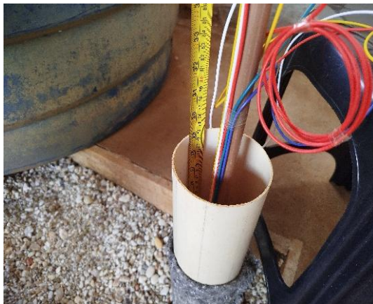
Figura 40: dispositivo piezométrico com escala graduada.
