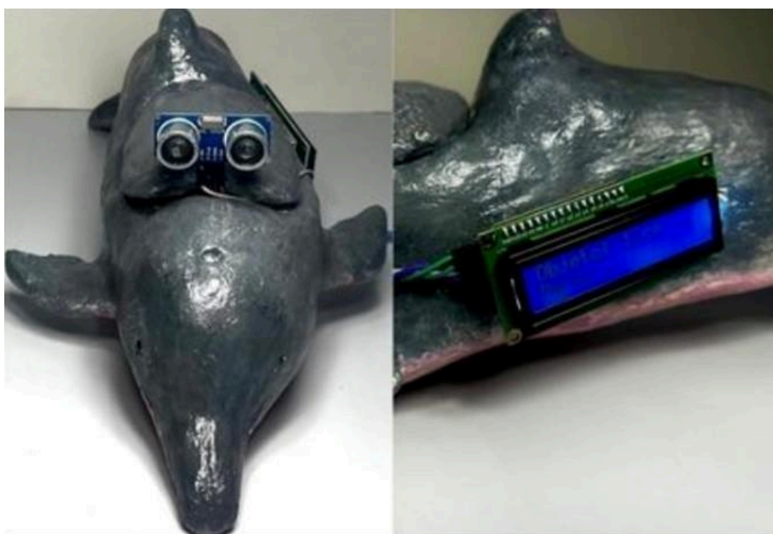
Figura 7 - Modelo 3D de boto com sensor ultrassônico e monitor LCD acoplado.
