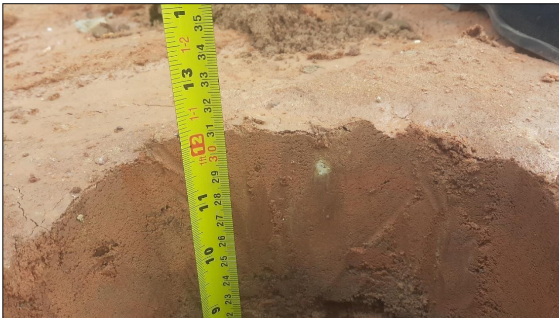
Figura 29 – Pré furo de 30 centímetros de profundidade.
