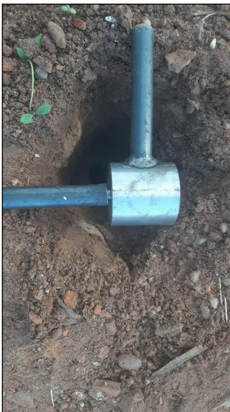
Figura 36 - Falha estrutural da bigorna Local 4.
