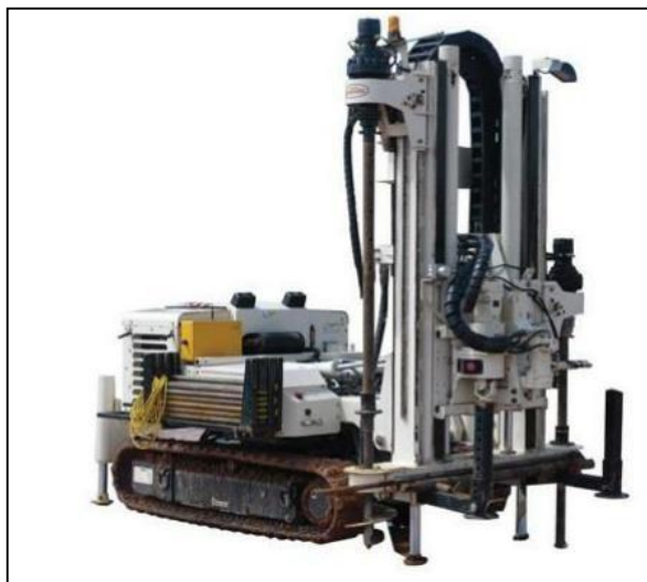
Figura 4 – Exemplo de sistema de cravação (Trator esteira)
