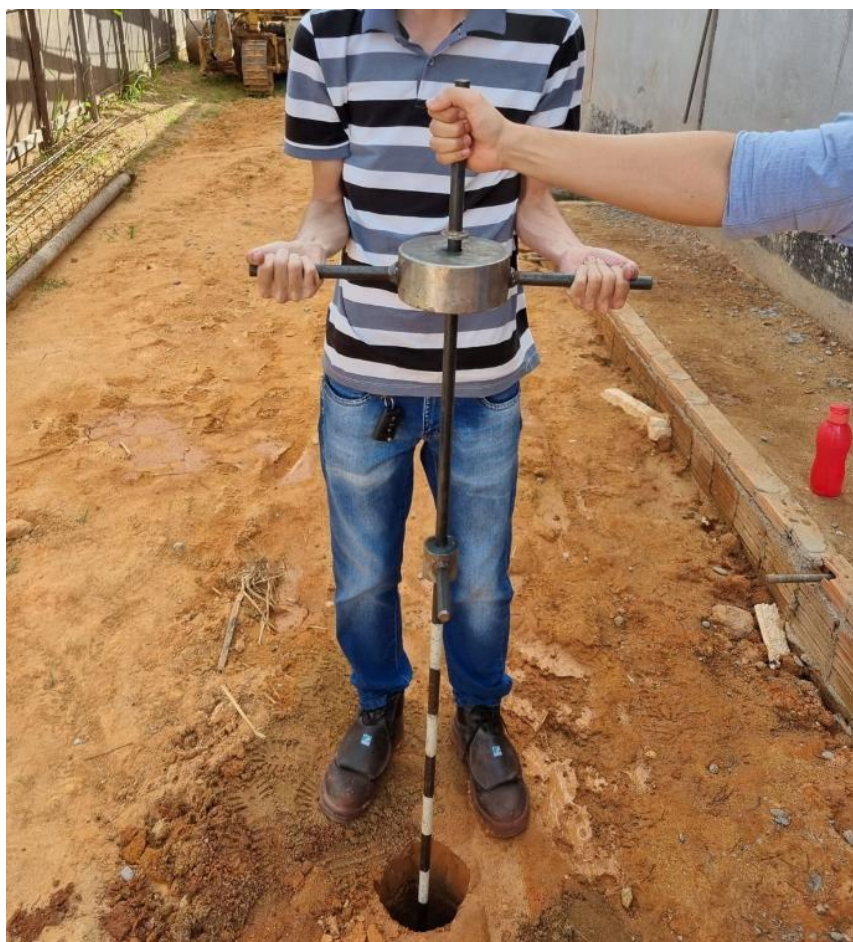
Figura 32 - Procedimento de golpes do Martelo.
