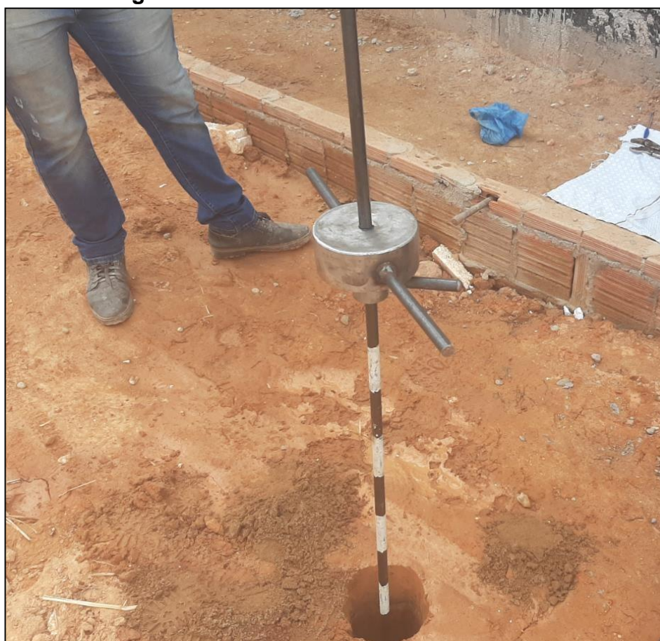
Figura 31 – Posicionamento do DPL no solo.
