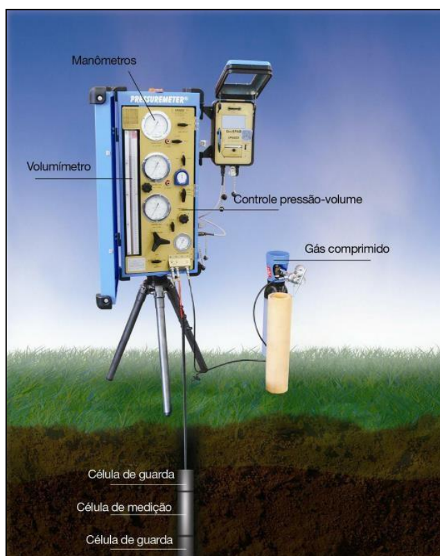
Figura 14 – Ilustração do pressiômetro tipo Ménard.
