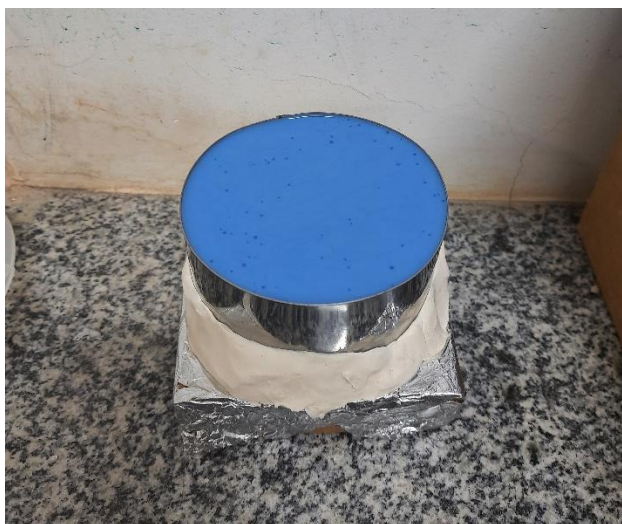
Figura 5: Molde de silicone produzido para incorporar as escamas.
