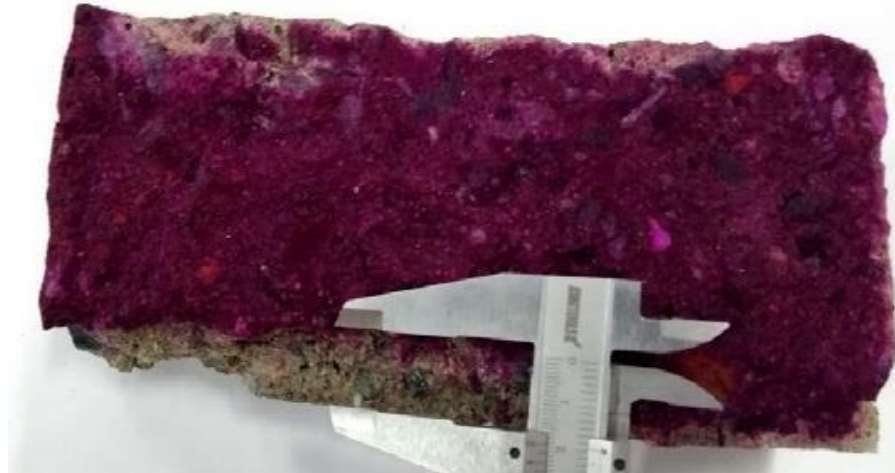
Figura 11-Corpo de prova com aspersão de fenolftaleína
