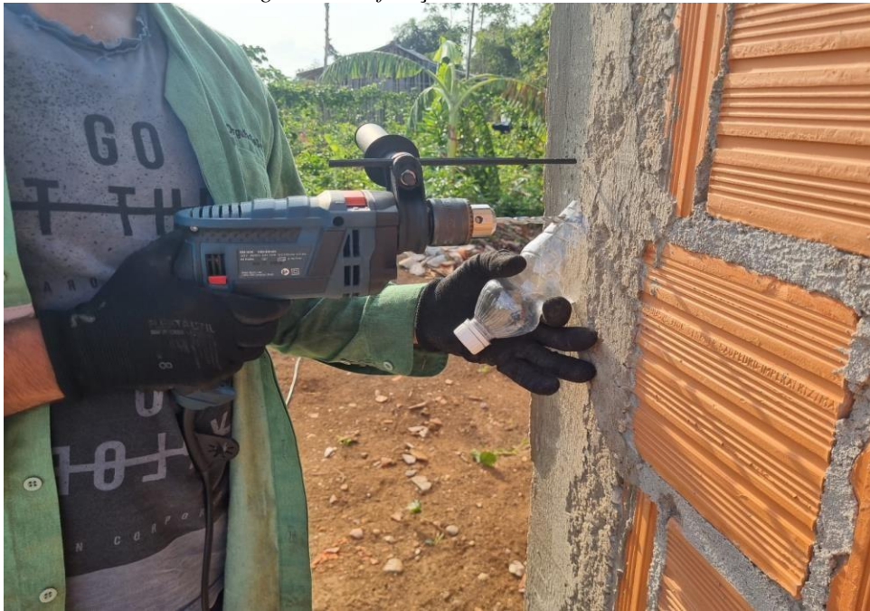
Figura 20-Perfuração e coleta de amostra
