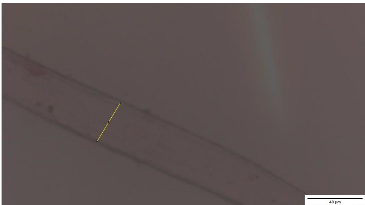
Figura 8 – Mensuração da largura da fibra da madeira de K. grandifoliola aos 4 anos de idade cultivada na região Tocantina do Maranhão.
