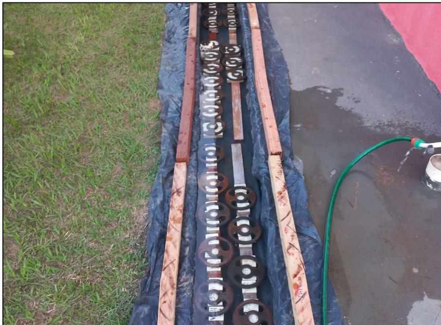
Figura 1: CPs em processo de saturação. Fonte: Autor (2023).
