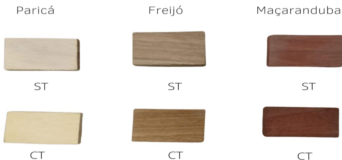
Figura 11. Corpos de prova das espécies antes (ST) e após (CT) o tratamento superficial.
